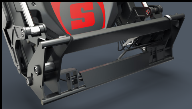
HYDRO-LOCK. Dispositivo per il bloccaggio degli attrezzi con la pressione di un pulsante, cambio di attrezzo ancora più comodo, senza lasciare la cabina di guida.
